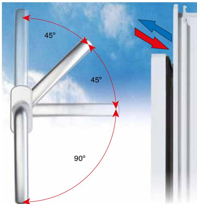
Данная ручка может фиксироваться под углом 45°, приводя к автоматическому откидыванию створки на 10-13 мм. Сочетание с ножницами для микропроветривания MACO является оптимальным.
